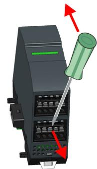
8. ➔ Entfernen Sie die überflüssigen Steckverbinder.
