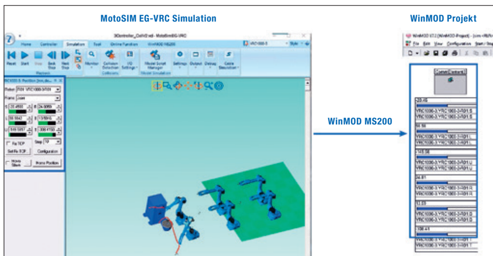
Darstellung der Übermittlung der Achswerte eines Roboters aus MotoSIM EG-VRC (links rot markiert) und der über das Plug-in WinMOD MS200 übertragenen Werte (rechts rot markiert). Die Achswerte auf der WinMOD-Seite entsprechen den Achswerten von offline programmierten Robotern.
