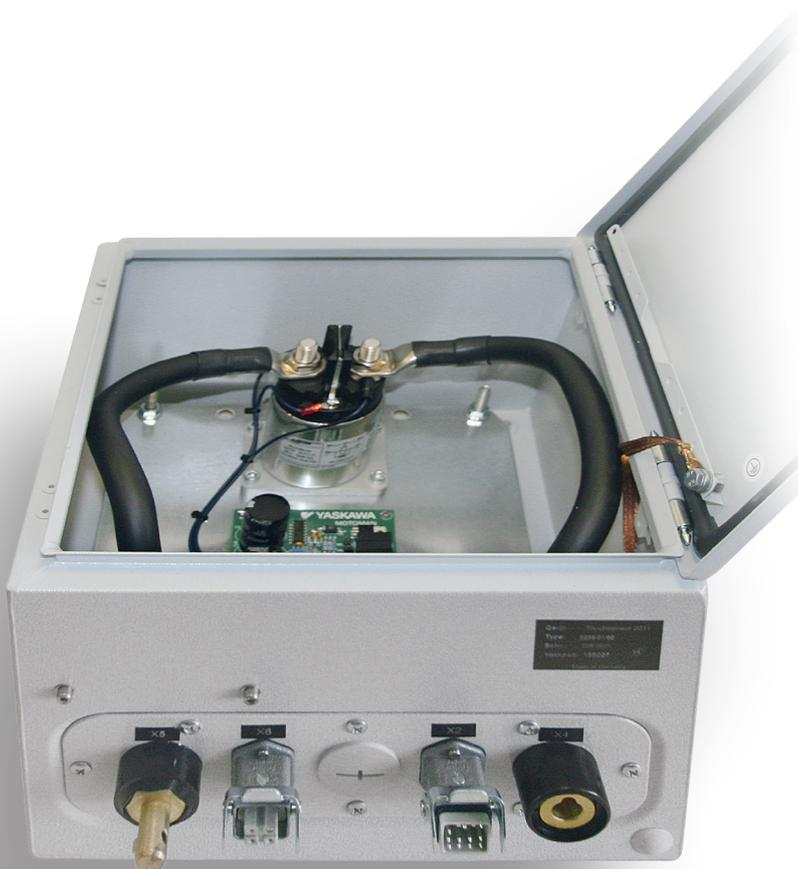
Der YASKAWA-Touchsensor nutzt den Draht des MIG-/MAG-Schweißbrenners zum Suchen der genauen Lage von Schweißnähten. Trotz vieler Sensoriken werden vor allem im groben Stahlbau weiterhin Schweißnähte mit dem Schweißdraht gesucht, da dieser keine Störkontur auf dem Schweißbrenner aufbaut.
